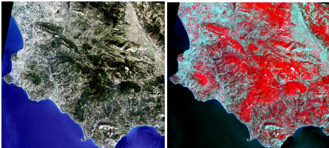
Figura 42 - Parte del frame multispettrale (30 m) Landsat dell'area di studio: a) composizione in colori reali, b) composizione in falsi colori.
