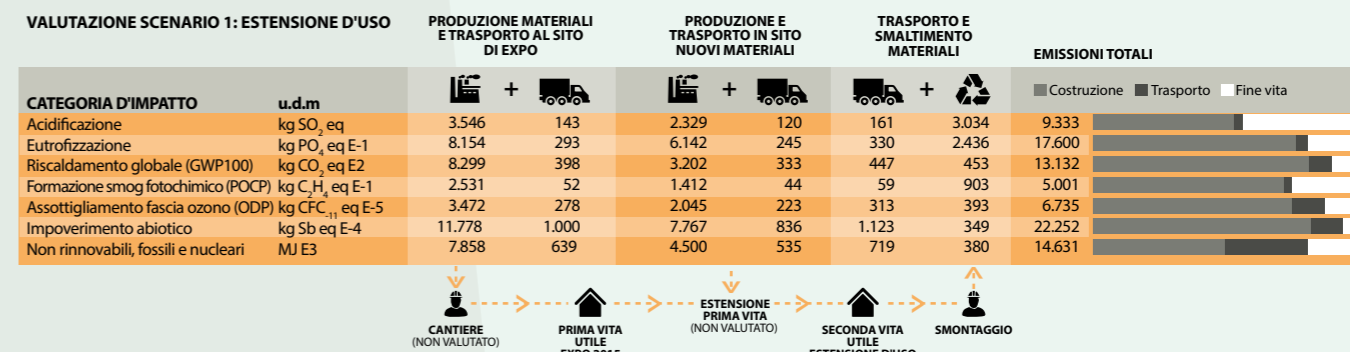
Figura 5. Impatti ambientali LCA dello scenario di fine vita 1 (estensione d'uso in loco).
