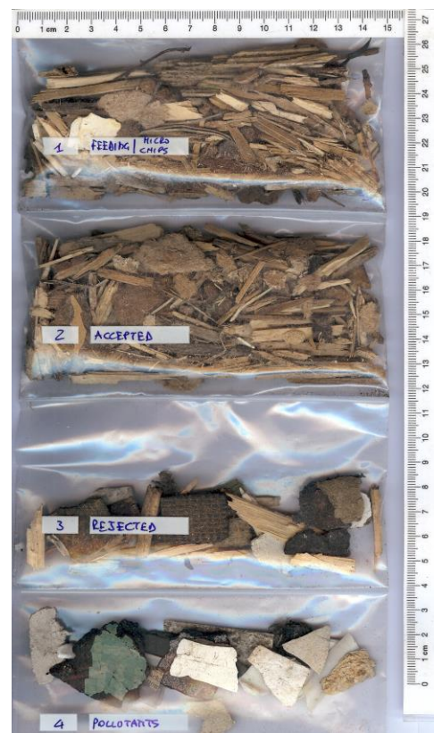
Figura 3 – Campioni di materiale usato per i test. L'immagine mostra, da sinistra verso destra, il materiale in ingresso, il legno accettato, gli inquinanti e le plastiche scartate scartate.
