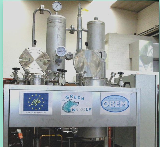
Figura 5 Impianto sperimentale di idrolisi della lana (Foto Vilmer Ginevro, OBEM)
