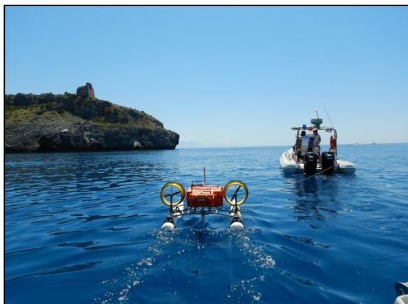
Figura 5: Il veicolo autonomo di superficie DEVSS “DEvelopment Vehicle for Scientific Survey” in azione nel Parco Nazionale del Cilento, Vallo di Diano e Alburni.
