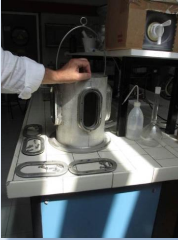
Prototipo 1 per reazioni in discontinuo. La combustione avviene su batch di campioni singoli o multipli. (Foto: progetto LIFE FIBERS)
