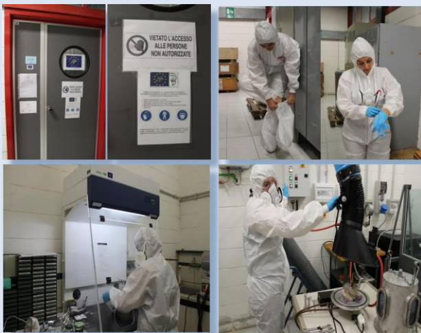
Lavorazione insicurezza dei rifiuti contenenti amianto nel Safe and Clean Lab dell'Università di Genova durante i test sul Prototipo 1 Foto: progetto LIFE FIBERS
