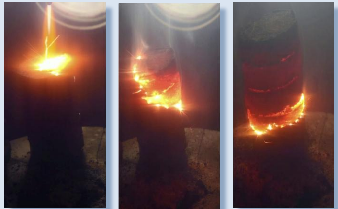
Sequenza che illustra la reazione SHS, nel prototipo 1 alimentato in discontinuo (Foto: progetto LIFE FIBERS)
