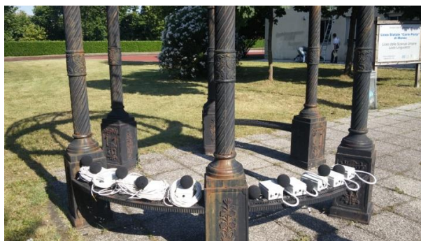
Figura 4 – Sensori della rete di monitoraggio acustico low cost (foto: staff LIFE MONZA)
