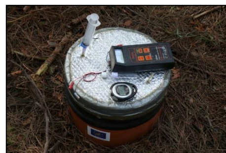
Figura 4 – Camera statica per il campionamento di gas ad effetto serra (foto: Alessandro Elio Agnelli)
