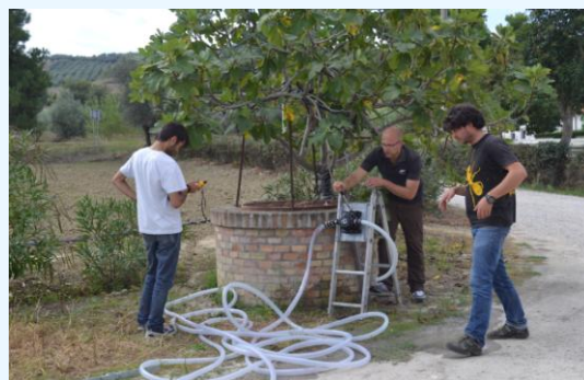
Prelievo Campionamento della fauna di acquiferi alluvionali mediante l’utilizzo di una pompa a membrana in un pozzo; bacino del fiume Vomano (TE) (Foto: immagini del Laboratorio di Stigibiologia-UNIVAQ)
