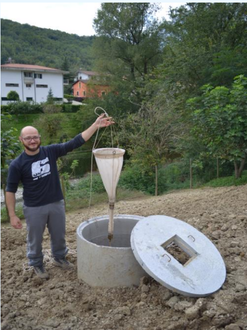
Campionamento della fauna di acquiferi alluvionali mediante l'utilizzo del retino Cvetkov in un pozzo; bacino del fiume Vomano (TE) (Foto: immagini del Laboratorio di Stigobiologia-UNIVAQ)
