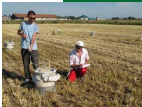
Sistema di camere statiche circolari, volume 37,7 dm 3 alloggiato su frame circolari fissati al terreno con volume complessivo (spazio di testa) di 63,1 dm 3 per campionamento di gas GHG dal suolo (Foto Azienda Sperimentale "Vittorio Tadini")
