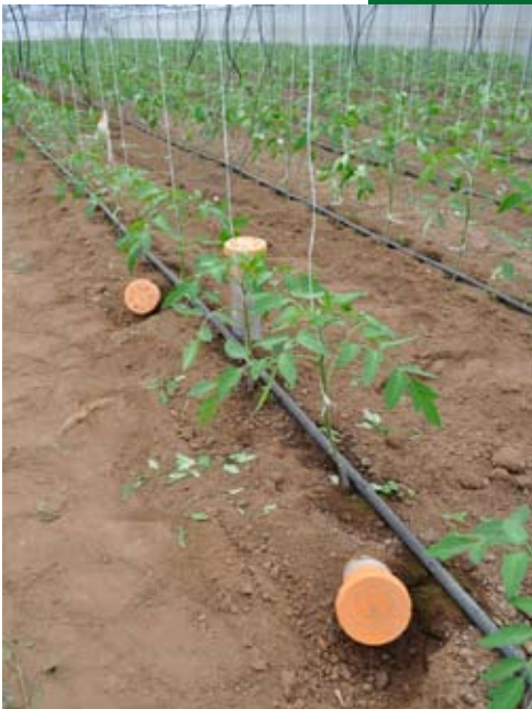
Strumentazione per il rilevamento non distruttivo della crescita delle radici nelle piante di pomodoro: le radici crescono attorno a tubi di plastica trasparente nei quali viene immesso settimanalmente uno scanner che ne "fotografa" lo sviluppo (Foto Stefania Betti)
