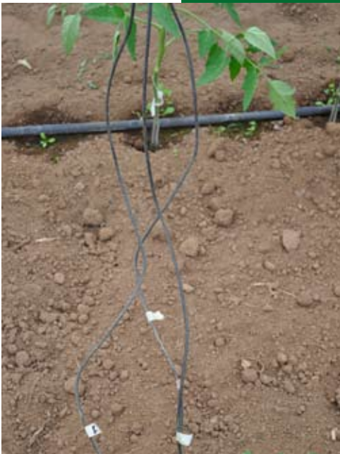
Sensori FDR di rilevamento dell'umidità del suolo per monitorare con esattezza le necessità idriche delle piante (Foto Stefania Betti)
