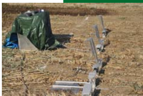
Sistema di camere statiche automatizzate (prisma trapezoidale), volume 13 dm 3 per campionamento di gas GHG dal suolo (Foto Azienda Sperimentale "Vittorio Tadini")
