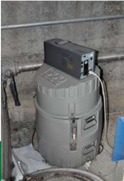
Foto 1 Autocampionatore (Teledine ISCO 6712 full size) utilizzato per effettuare campionamenti delle acque in ingresso e uscita al depuratore di S. Pietro Vara, comune di Varese Ligure (SP) (Foto Stefania Betti)
