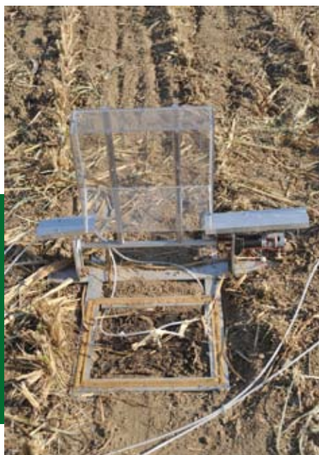
Dettaglio del sistema di camere statiche automatizzate (prisma trapezoidale), volume 13 dm 3 per campionamento di gas GHG dal suolo (Foto Azienda Sperimentale "Vittorio Tadini")
