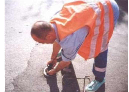
Prelocalizzazione Perdite con Noise Loggers
