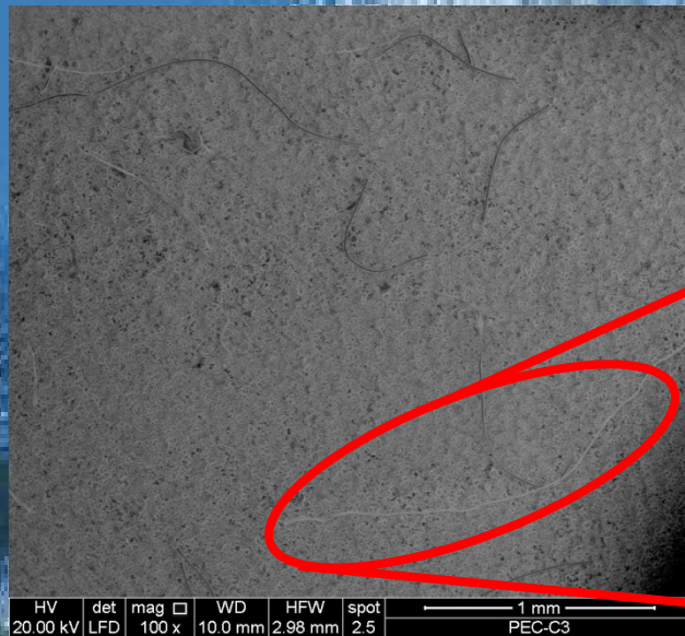
Immagine SEM di un'aria del filtro ( A_s = 7.8 mm 2 ) contenente fibre di PEC
