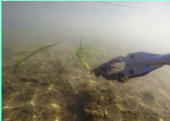
Utilizzo della pinza per il trapianto dei rizomi nel sedimento
