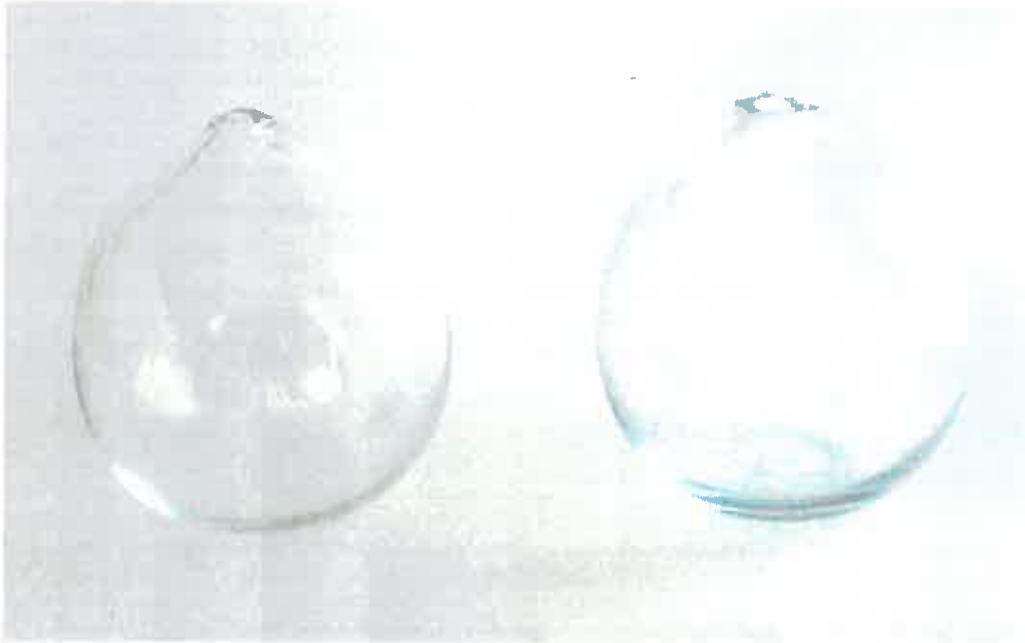
Figura 6 – Provini prodotti nella vetreria B con 1.0 kg di loppa (a sinistra) e 1.5 kg di loppa (a destra)
