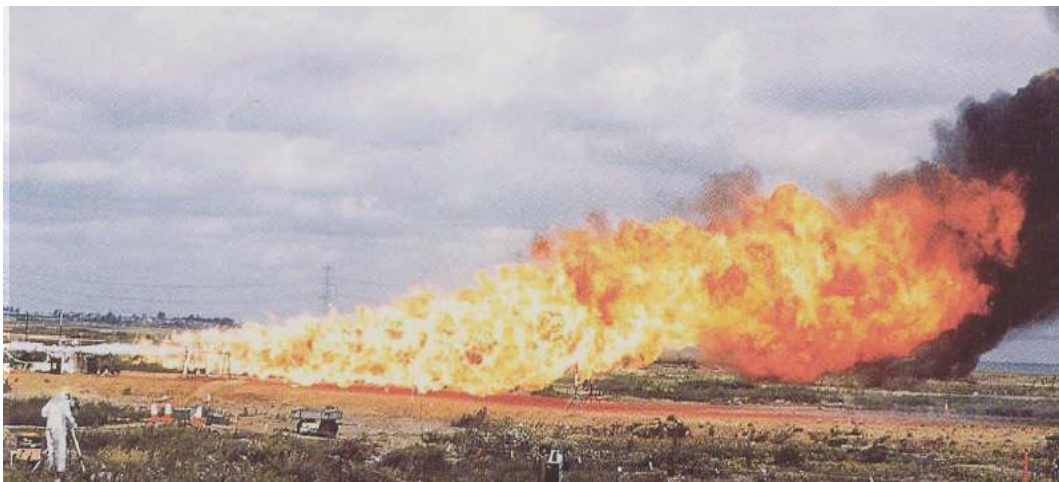
Fig. 30 Jet fire orizzontale
