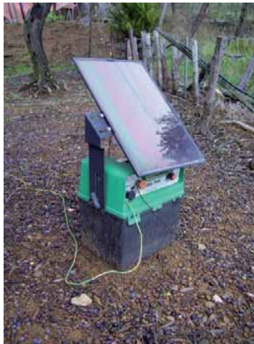
Figura 3 – Alimentatore per recinzione elettrificata dotato di pannello solare.
